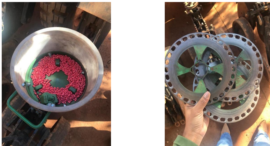
Figura 3. Reservatório de sementes e discos horizontais dosadores de sementes.
