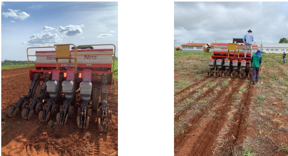
Figura 2. Semeadoras em sistema convencional e SPD.
